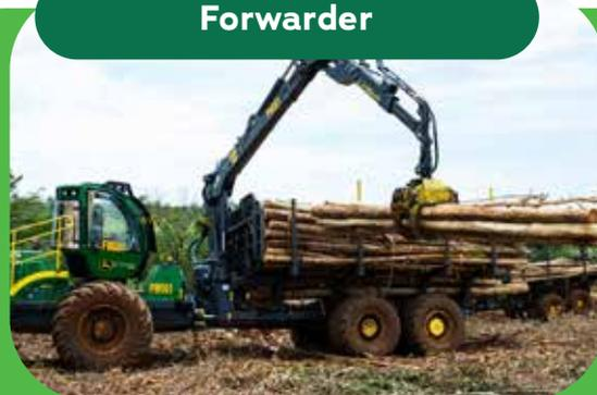
Realiza a operação de baldeio da madeira, que é a retirada das toras processadas de dentro do talhão até a margem das estradas, onde serão confeccionadas pilhas de madeira para posterior transporte até o site industrial.
