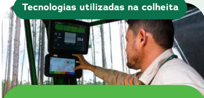
**Colheita digital:** utilizada para o monitoramento da operação de colheita e equipada com ciclos produtivos automáticos, *status* de produção, telemetria e sensoriamento remoto de máquinas (HV e FW).
