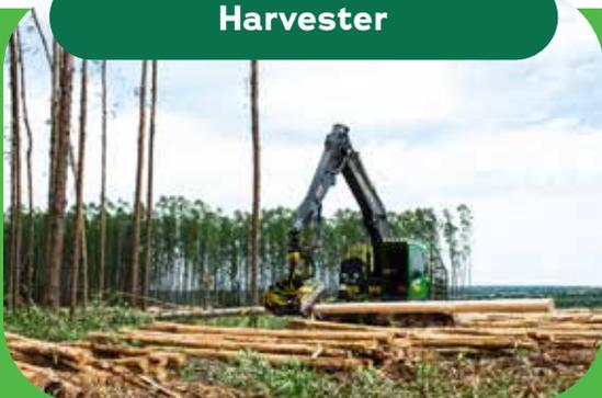
Executa a atividade de derrubada da árvore, descascamento, desganhamento e traçamento nas dimensões preestabelecidas, deixando a madeira esteirada em formato de faixas para o posterior processo de baldeio, que ocorre em média 10 dias após o corte.
