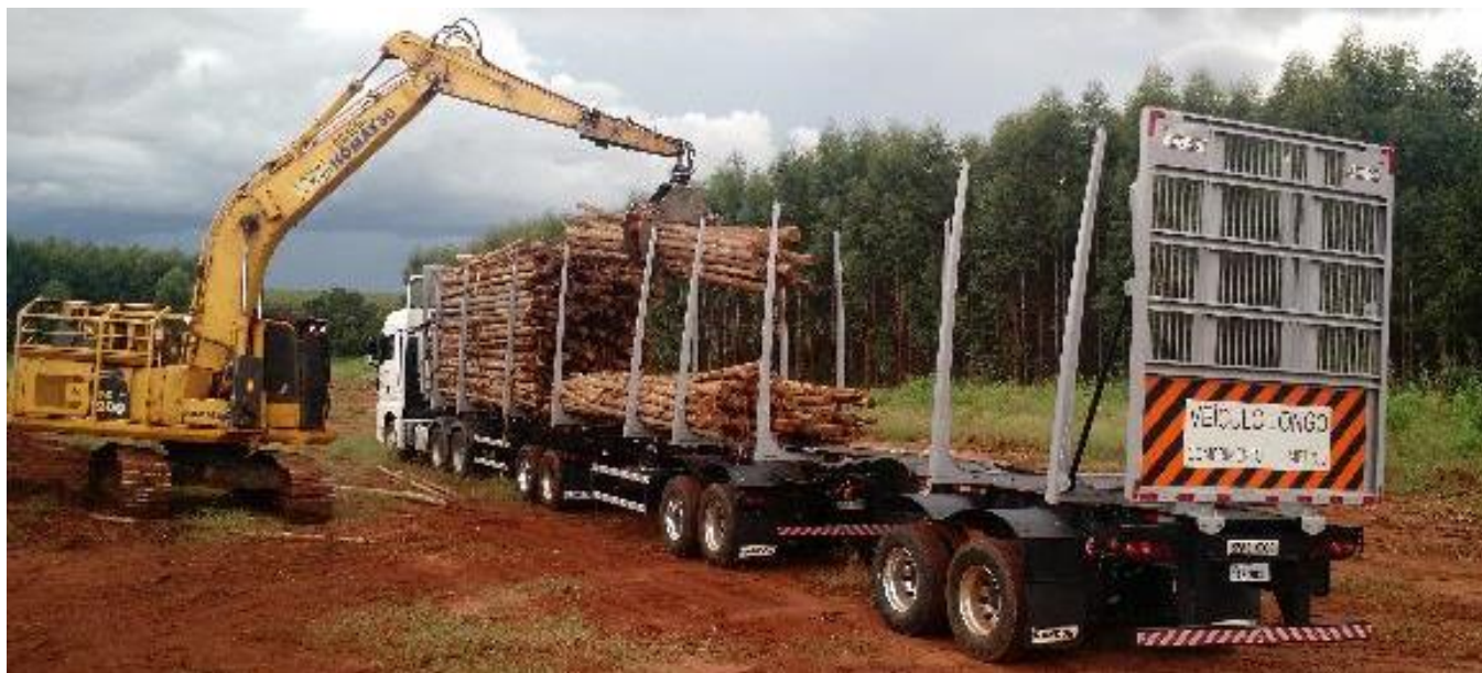
Figura 19: Operação de carregamento de um caminhão tri trem de madeira.
